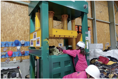
古着の圧縮作業をするスタッフ。衣類が傷まないように10分以上かけてゆっくりと圧縮し、専用のシートに包んでひもをかけます
